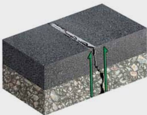
FIGURA 1: Las grietas migran hacia la superficie en una sobrecarpeta no reforzada.
