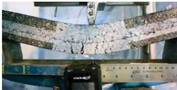
GlasGrid TF otorga una adhesión superior en la sección transversal del pavimento minimizando las grietas y maximizando el desempeño.
