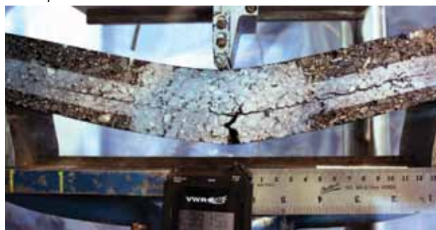
El sistema original GlasGrid con una cobertura adhesiva convencional reorienta exitosamente las grietas extendiendo la vida útil del pavimento.
